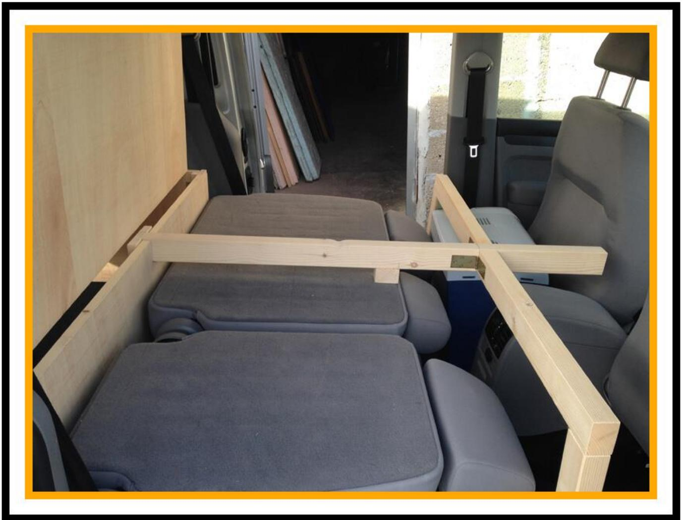
Hier siehst Du die gesamte Konstruktion über der umgeklappten Rückbank. Damit Du die Liegefläche komplett nutzen kannst, musst Du den Fahrer- und Beifahrersitz ganz nach vorne ziehen und die Rückenlehnen aufrecht stellen.
